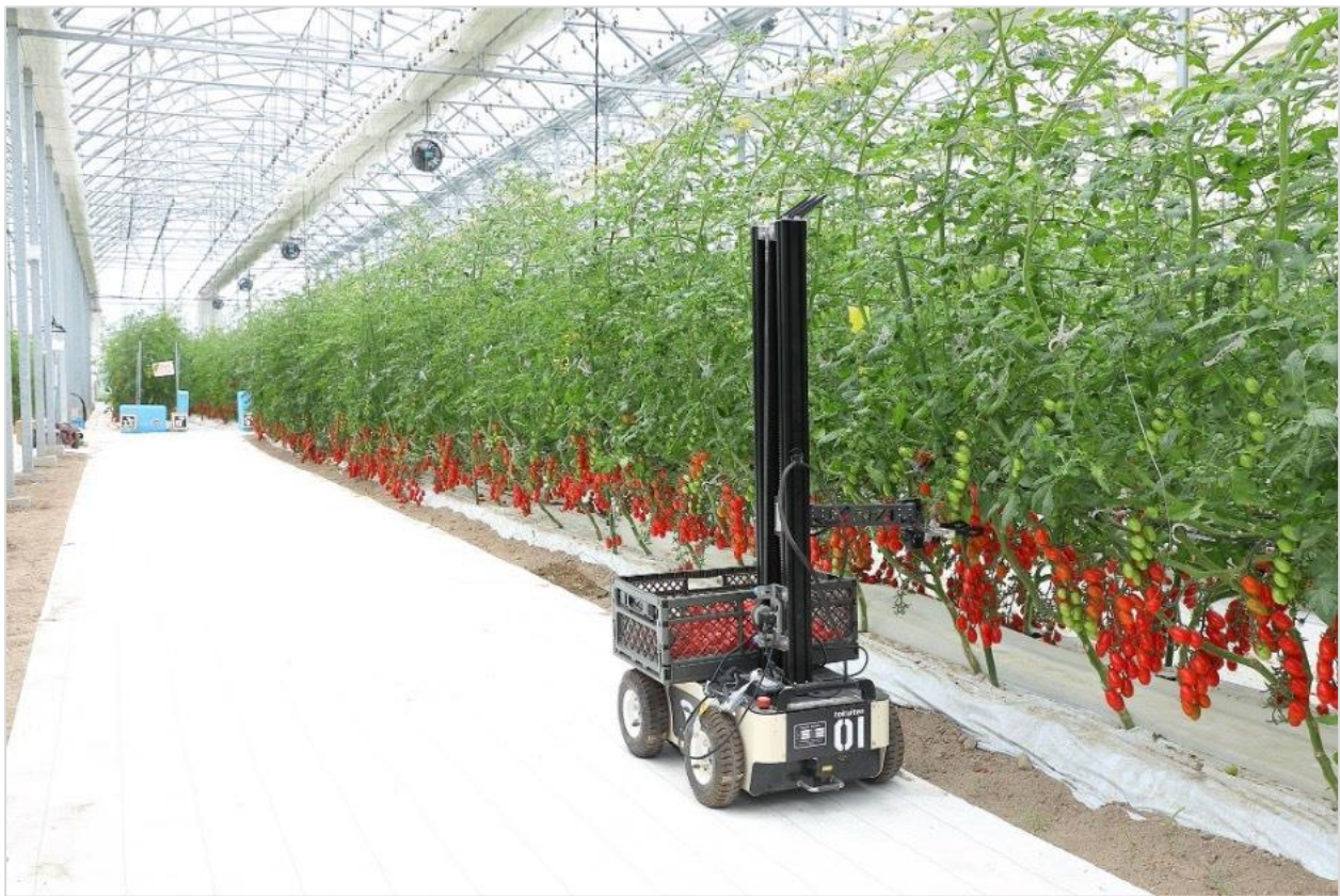
AIや遠隔制御によって自律的に農作業を行う、農業ロボット「ティターン」
